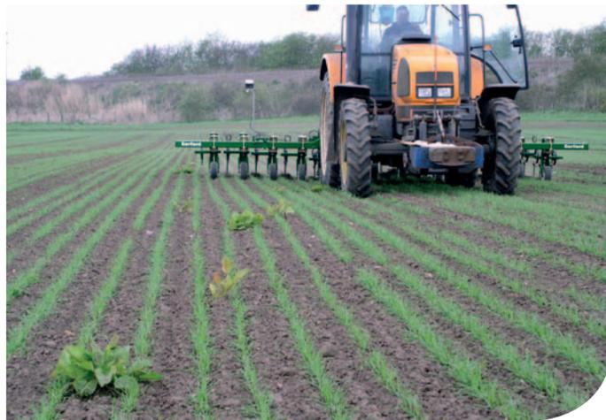
Гарфорд может поставить жесткие или гидравлические складывающиеся рамы с рабочей длиной до 12 метров. Имеются задненавесные и передненавесные модификации. Также имеется навесная система категории 2 для длин до 6 метров.
